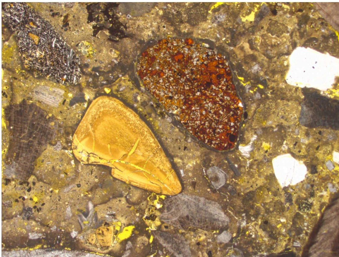
Fig. 51. Likhuset Kirkjubøur Färöarna. Bruksprov Lik Fö 2. Visar material, förmodligen en benflisa av samma typ som i bruksprov Sock Fö 4. Det är förmodligen animaliskt protein. Bildytan motsvarar 5,3 \times 4 \text{ mm}^2 . Foto: SP 2008.
