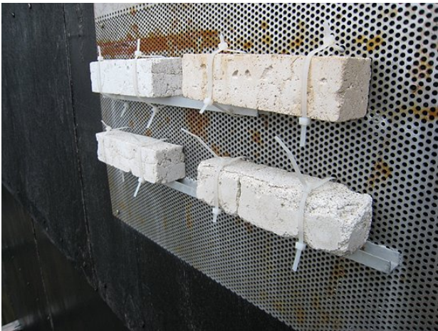
Figur 2.5. Mørtelprøver monteret på sydsiden af Muren for test af vejrbestandigheden. Metastar-mørtlen nederst th. var den mest nedbrudte af de fire prøver.
