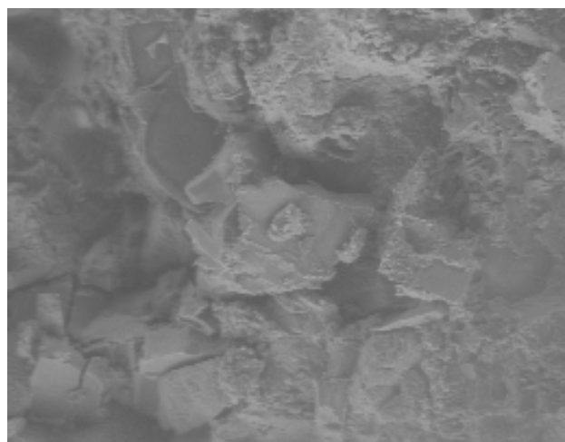
Figur 1.6. Nærbillede af overfladen på basaltprøve forurenet med salt. De kubiske krystaller nedbryder materialets struktur.
