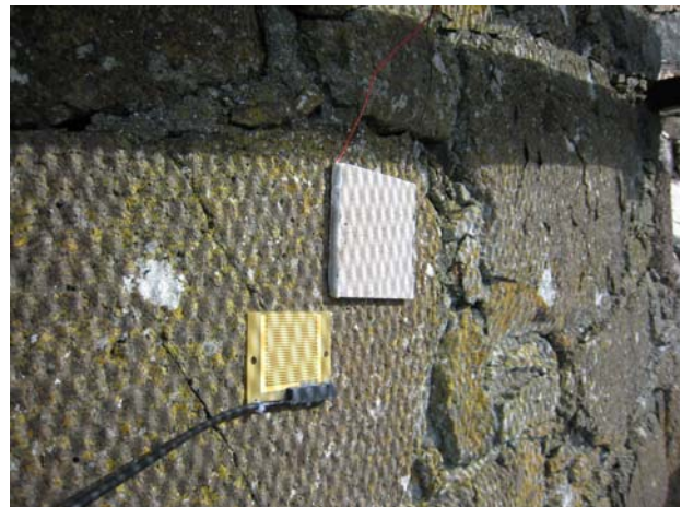
Figur 3.4. Placering af overfladefugtmåler og overfladetemperaturføler på den sydvendte overflade bag den perforerede afskærmning.
