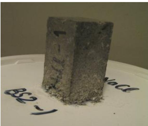
Figur 1.5. Prøve af porøs basalt efter 30 dages opsugning af 1% saltopløsning. Overfladen smuldrer som følge af saltets krystallisation
